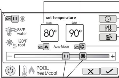
**Température de consigne** - Les températures de consigne du système de chauffage/refroidissement principal et du solaire sont indiquées dans ces cases. Les points de consigne peuvent être modifiés à l'aide des curseurs situés en bas ou en appuyant sur la case et en saisissant la température manuellement.
