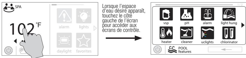
Les différents boutons affichés dans l'écran de fonctionnalités de l'espace d'eau sont liés à la configuration initiale. Par exemple, si vous avez configuré un chauffe-eau au gaz pour chauffer l'espace d'eau du spa, les réglages de chauffage du chauffe-eau au gaz seront alors affichés dans les écrans de fonctionnalités du spa.
